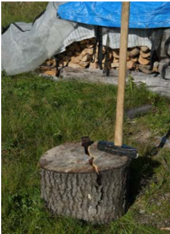
Kile og slegge brukes på de største kubbene. Her settes kilen i ytterkant av kubben.
