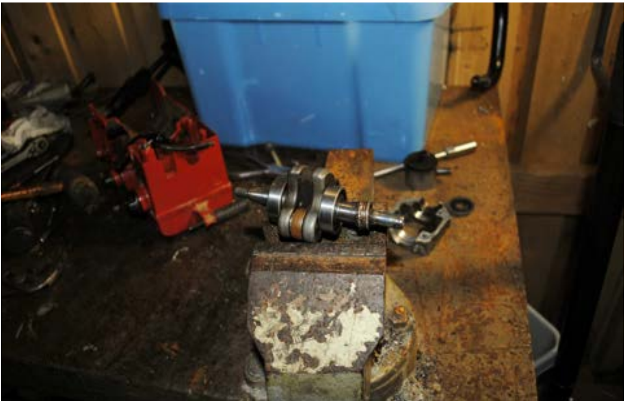
Drevet til kjedeoljepumpa er utslitt, og motorsaga må demonteres for reparasjon.
