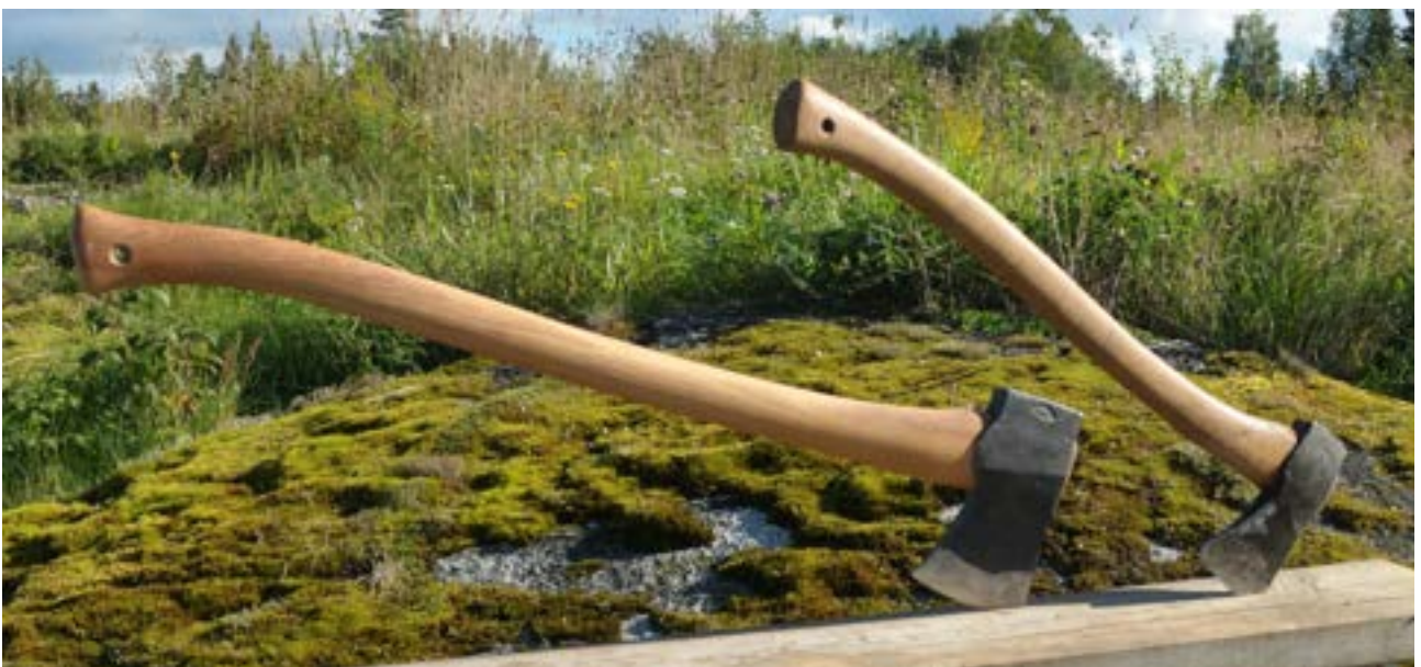
Stor og liten skogsøks, maskinsmidde fra wetterlings. Skogsøkse brukes ved trefellig. Den har en skarpere egg og egner seg best til kvisting og kapping.
