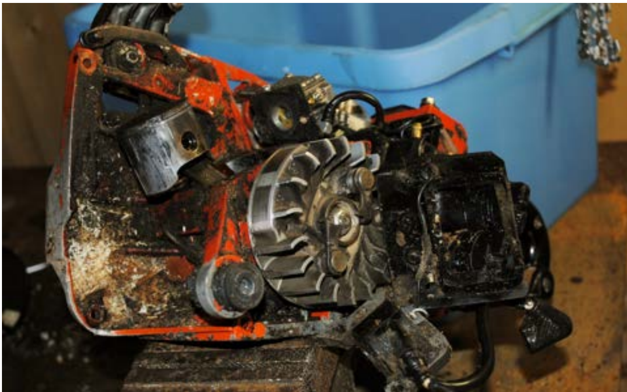
Skjærings, her har stemplet på JoBu'n fra 1980 smelta sammen med sylindren.
