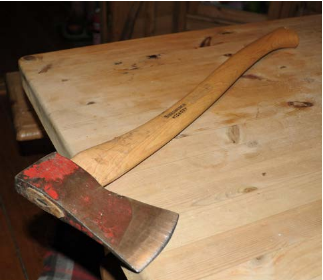
Øyo-øks (Geilo) som er skafta om med et Smedbergs hickory skaft.
