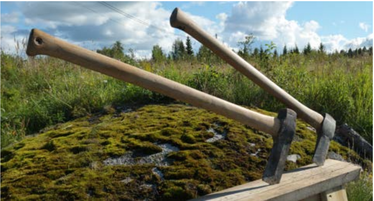
Kløyveslegge og kløyvøkse brukes på de store kubbene, disse er også maskinsmidde fra Wetterlings. Kløyvøkse har en rundere egg enn skogsøkse.
